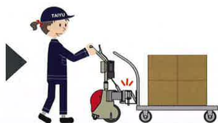
② パワーアシストユニットのアタッチメントを台車のアタッチメントに取付ける。
