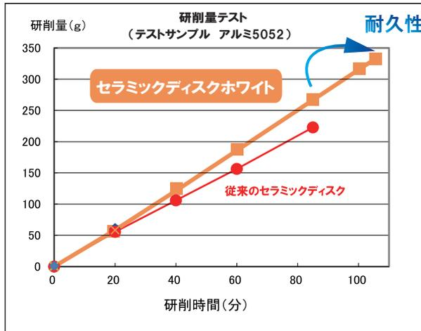
セラミックディスクホワイトは従来のセラミックディスクに比べ特にアルミ研磨に高い研削力を発揮します
